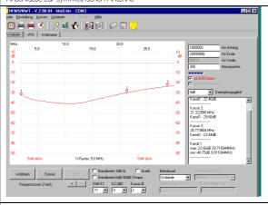
Gleichtaktdämpfung = Wirkung gegen Gleichtaktströme
