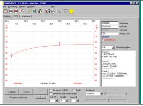
Eingangsreflexion = Abweichung vom "Ideal"  $50~\Omega$  Verfälschung durch das Einfügen des Baluns in den  $50~\Omega$  Signalweg.
