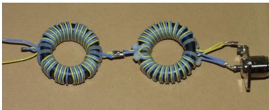
Es sind die 50 Ω Seite des Breitbandtransformators, links im Bild, mit irgendeiner Seite des Baluns (Typ Sperrglied) 50 Ω zu 50 Ω (1:1), rechts im Bild, zu verbinden. Links ist die 200 Ω Seite, rechts die 50 Ω Seite des so entstandenen Balun 50 Ω zu 200 Ω (1:4). Die Verbindung zwischen beiden Kernen sollte sehr kurz sein. Für längere Verbindungen ist 50 Ω Leitung, z.B. Koaxialkabel oder verdrehte Leitung zu verwenden.
