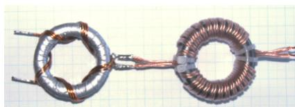
Die 50 Ω Seite des Breitbandtransformators (links im Bild) wird mit irgendeiner Seite des Baluns (Typ Sperrglied) 1:1 (rechts im Bild) verbunden.
