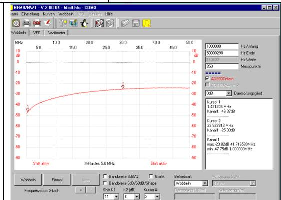
**Gleichtaktdämpfung** = Wirkung gegen Gleichtaktströme. Kern 7427015 und zweimal 12 Windungen Zweidrahtleitung. 25 dB entsprechen einem Widerstand gegen Gleichtaktstrom von 1,7 kΩ. Dieser Wert wird bereits bei 1,8 MHz fast erreicht und deshalb ist dieser Balun von 160m bis 6m einsetzbar.
